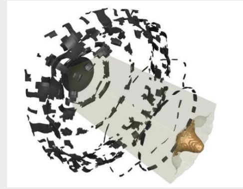
Patlama sonrası 'casing' ile S-ALE FSI
